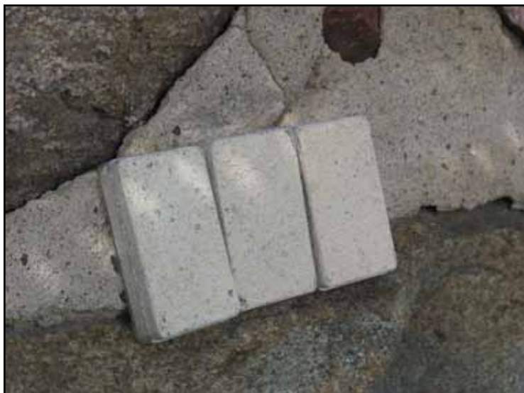
Utprovning av pigmentering för fognings- och putsbruk.
