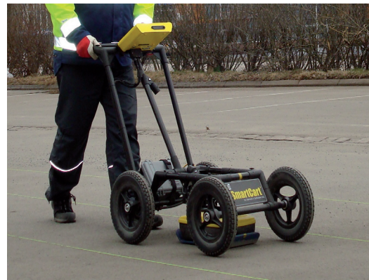
FIGUR 5. Georadar typ Sensors & Software NogginPlus 500MHz med Smart Cart.
