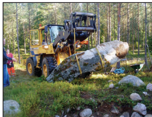
FIGUR 6. Stenen lyfts försiktigt på plats i tygstroppar.
