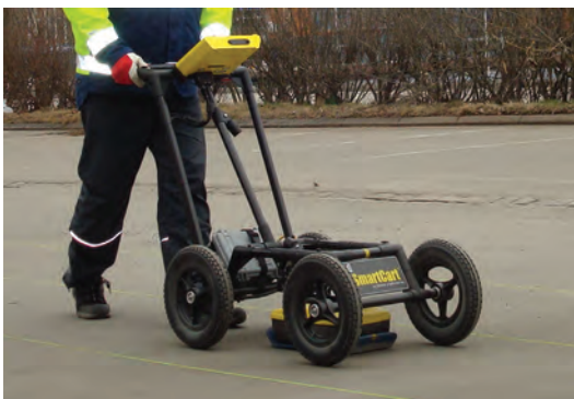
FIGUR 7. Georadar typ Sensors & Software NogginPlus 500 MHz med Smart Cart. Den typ av teknisk utrustning som utnyttjats vid kartering av Jönköpings slott 2010 - 2011. Foto Kennet Stark.
