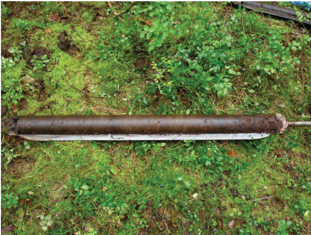
Figur 3. På bilden syns borrhkannen med den nedre delen av lagerföljden som provtagits på ett djup mellan 35 och 135 cm under markytan. Lagerföljdens botten, 135 cm, finns till vänster i borrhkannen. Foto: Leif Björkman.
