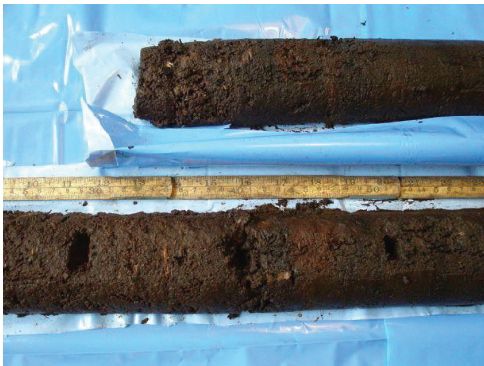
Figur 6. Detaljbild som visar ett avsnitt av den övre delen av lagerföljden där den övergår från vitmosstorp till kärrtorv. De små hålen vid 30, 40 respektive 50 cm visar var pollenprover har tagits. Foto: Leif Björkman.
