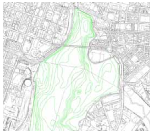
FIGUR 38. Munksjöns branta bottenprofil. Djupkurvor med 2 m ekvidistans. Karta upprättad av Tekniska kontoret, Jönköpings kommun.
