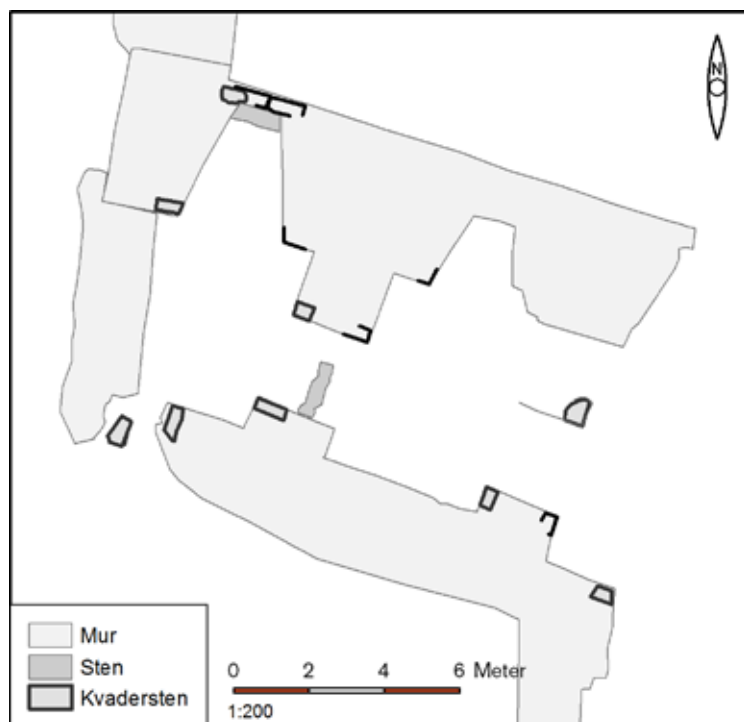
FIGUR 47. Inmätta sandstenskvadrar samt omfattningssten i den västra kanonporten. Bastion Carolus norra flank.
