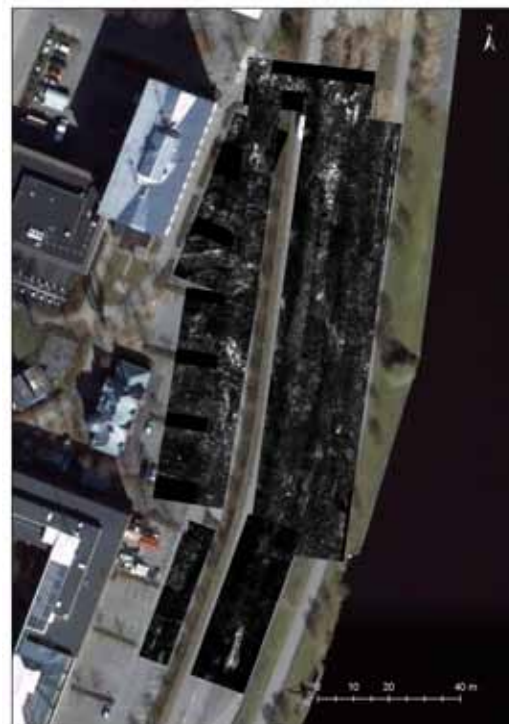
FIGUR 27. Georadarkartering av lämningar efter bastion Carolus och sjömuren. Bilden visar situationen 130 cm under befintlig markyta. Utförd på Västra kajen år 2010 av Lars Winroth, Modern Arkeologi KB.
