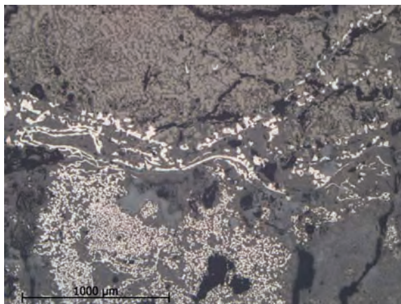
Figur 37. Prov 26B. Koncentration av svampigt metalliskt järn (vitt) i wüstitdominerande slagg. Foto från mikroskopet.
