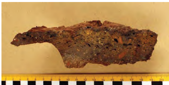
Figur 10. Prov 8 i tvärsnitt, med stenvtryck nere till vänster. Insidan mot ugnsutrymmet syns uppåt i bild.
