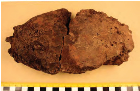
Figur 4. Bottenslaggerna prov 5 och prov 4 sedda underifrån.
