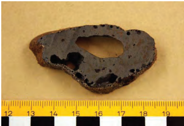
Figur 12. Tappslagen prov 10 i tvärsnitt. Ett sandskikt framträder i botten liksom ett stort centralt hålrum. Slaggen är homogen i sammansättning.
