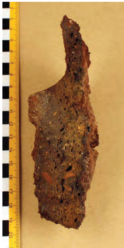
Figur 1. Foto av tvärsnitt av ugnsväggsfragment pr. 8. Den rundade kaviteten på vänster sida är avtrycket efter en större sten. Höger sida är ugnens insida. Foto L. Grandin, GAL.
