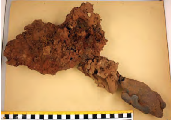
Figur 14. Bottenslagg i två delar (prov 11) och tappslag i prov 10, sedda ovanifrån. Bottenslaggen (ena delen) är långsmalt oval och har en utväxt (andra delen) ut mot tappprännen.
