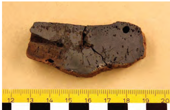
Figur 33. Tappslag prov 21B i genomskärning. Den är en homogent uppbyggd slagg med ansamling av små hålrum nära överytan. I botten finns ett tunt skikt av sand.
