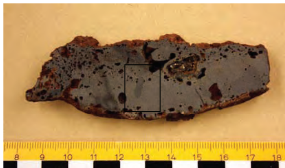
Figur 5. Prov 5 i tvärsnitt. Slaggen är huvudsakligen homogent uppbyggd men det förekommer dock inneslutna mindre slaggvolymer, droppar, av något avvikande sammansättning (nästa figur)
