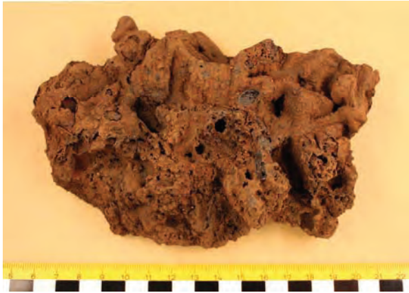
Figur 31. Prov 21A, bottenslagg med flera stora kolavtryck.
