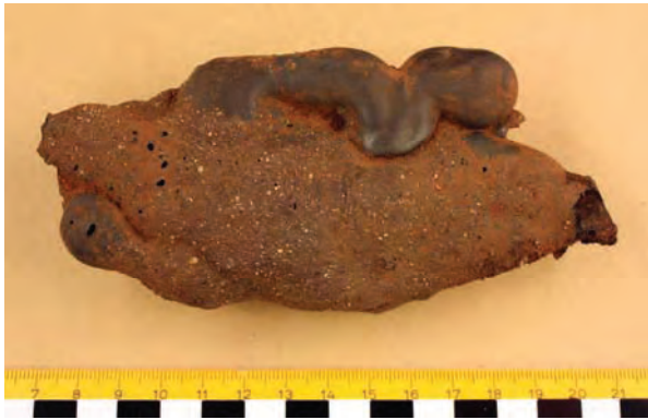
Figur 11. Tappslag, prov 10, från tapprännan vid norra ugnen sedd ovanifrån.
