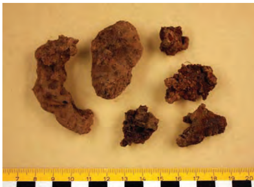
Figur 25. Prov 15. Såväl flutna som mer trögflutna småslagger påträffade under bottenslaggen i södra ugnen.
