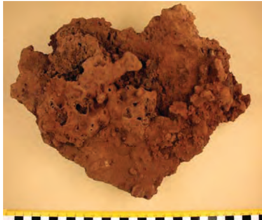
Figur 27. Prov 17, bottenslagg från den södra ugnen sedan ovanifrån.
