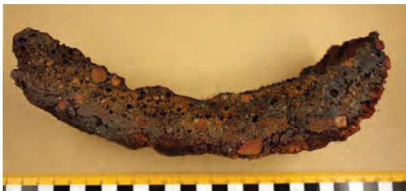
Figur 24. Prov 13 i tvärsnitt. Där framträder dess välvda form liksom en kärna av smält material, där dock de grövre fraktionerna inte är smälta, och med ett yttre skikt av bränd lera. Det inre skiktet (uppåt) utgörs av slag. Foto KFL.
