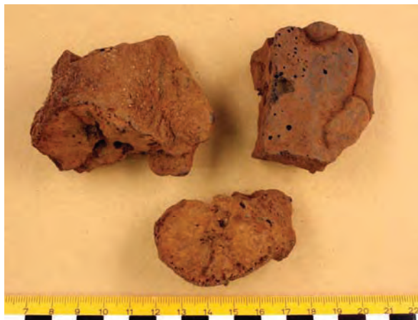
Figur 7. Exempel på fragment av tappslaggar ur prov 6. Överst till vänster botten, till höger överytan och nederst i genomskärning.
