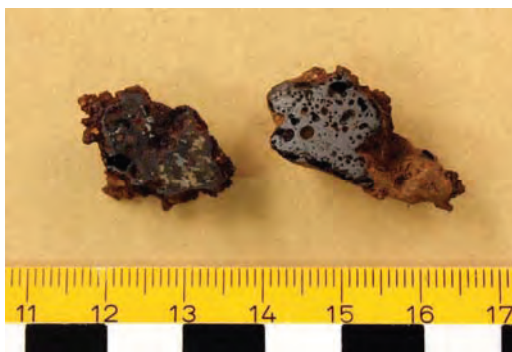
Figur 26. Prov 15. Några av småslaggena från föregående figur i tvärsnitt. Den högra innehåller homogen slagg, den vänstra även lite metalliskt järn.
