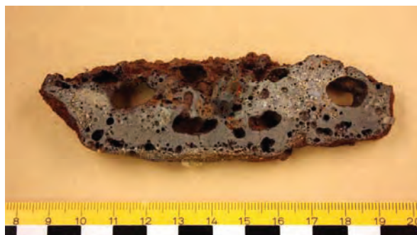
Figur 17. Prov 11B2, tvärsnitt genom centrala delar. Här framträder en betydligt mer komplext uppbyggd slag. Ett bottenlager av slagg följs av slagg blandat med kiselrikt material.
