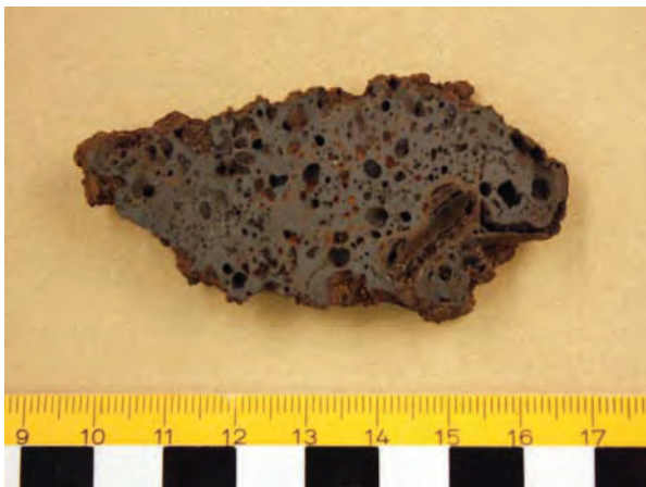
Figur 32. Bottenslaggen prov 21A i tvärsnitt. Slaggen är homogen i sammansättning och relativt rik på hålrum.
