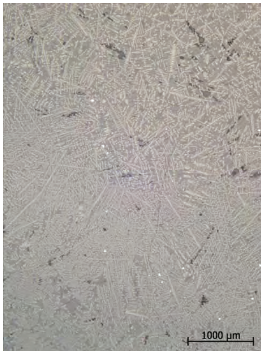
Figur 13. Detalj från botten av prov 10. Kornstorleken ökar tydligt nerifrån och uppåt. Foto från mikroskopet.
