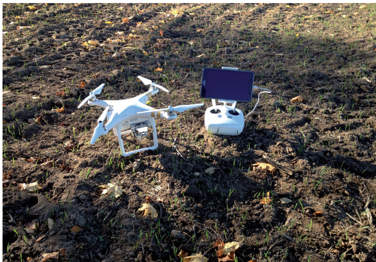
FIGUR 2. Drönaren som användes för att skapa ortofotot.
