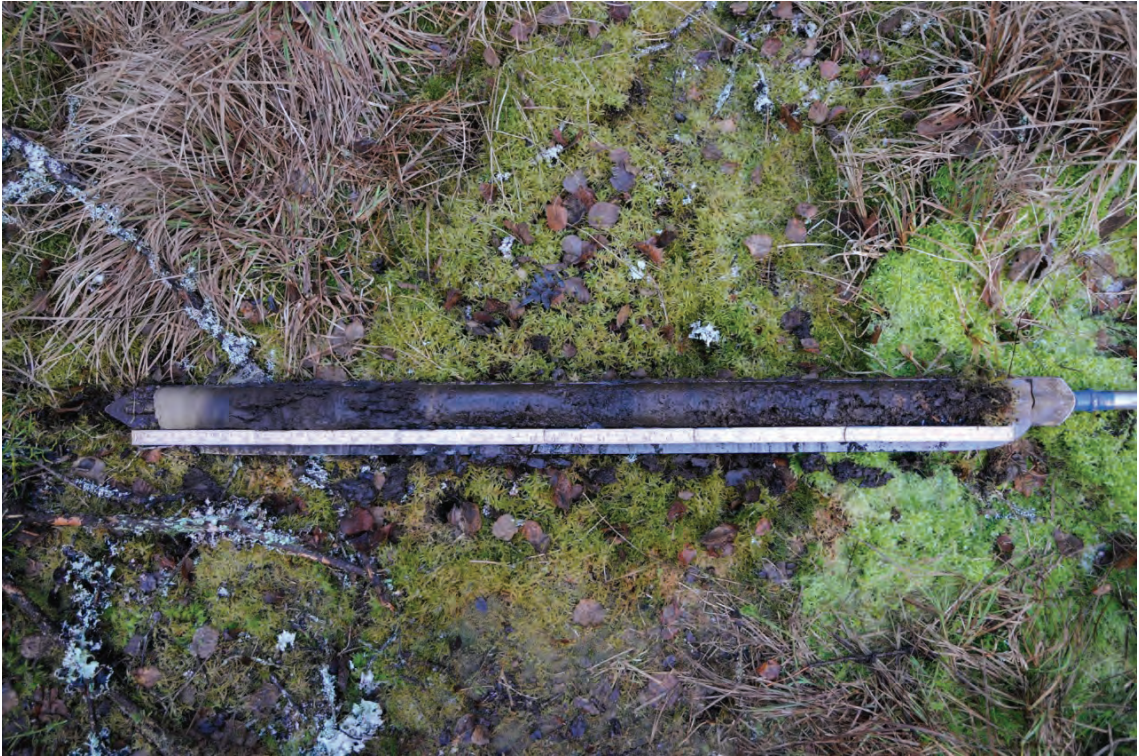
Figur 8. På bilden syns borren med den provtagna lagerföljden som omfattar 97 cm. Den utgörs till stor del av lövkärrtorv (se tabell 2). I botten av borrhöveln (till vänster i bilden) finns ett ljusare lager med sand. Foto: Leif Björkman, 2015-11-26.
