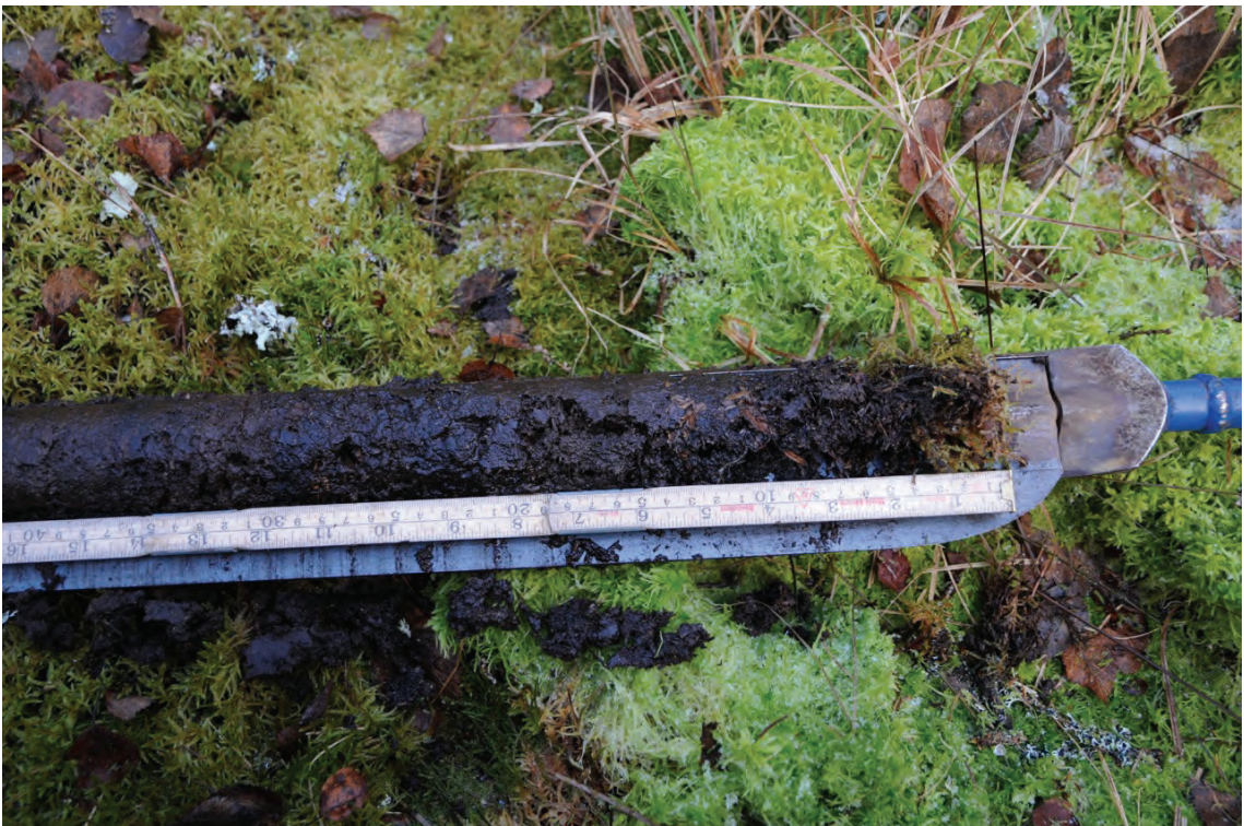
Figur 9. I toppen på den provtagna lagerföljden (till höger i bilden) finns ett lager med låghumifierad vitmosstorv. Vegetationens bottenlager vid provpunkten domineras av vit- och brunmossor. Foto: Leif Björkman, 2015-11-26.
