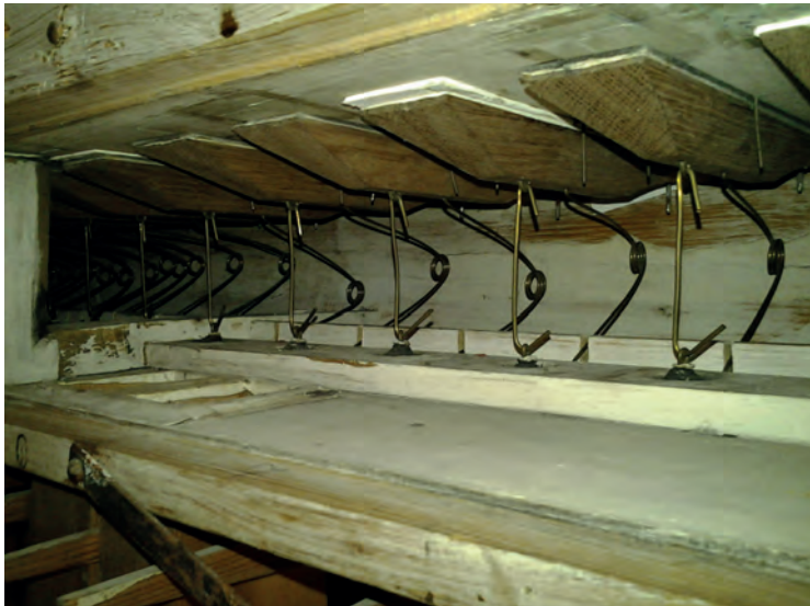
Ventilkistan är i hög grad i originalsckick. Ventilerna av ek har ändrats till svansupphängning och fasats av i framkant 1865. Den vita färgen är sannolikt även från den tiden. Foto: R. Gullbrandsson. The wind chest is in a highly authentic state, though the oak pallets were altered by Magnusson in 1865.
