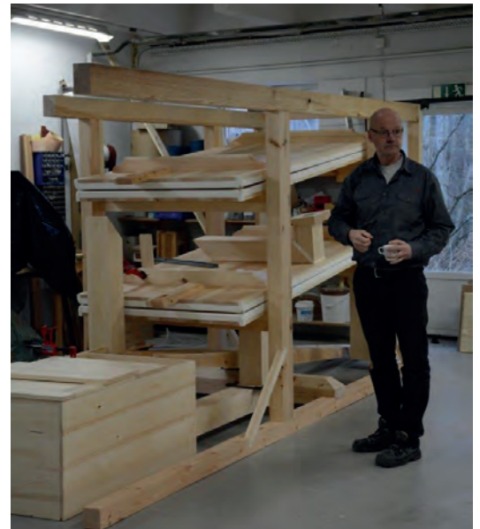
De nya kilbälgarna och lådan för fläktmotorn. Foto: R. Gullbrandsson. The new wedge-bellows.
