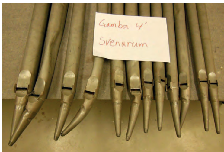
Gamba 4' med deformerade fötter och sönderstämda mynnningar. Foto: Bergenblad & Jonsson. Pipes damaged from a.o. tuning in Gamba 4'.
