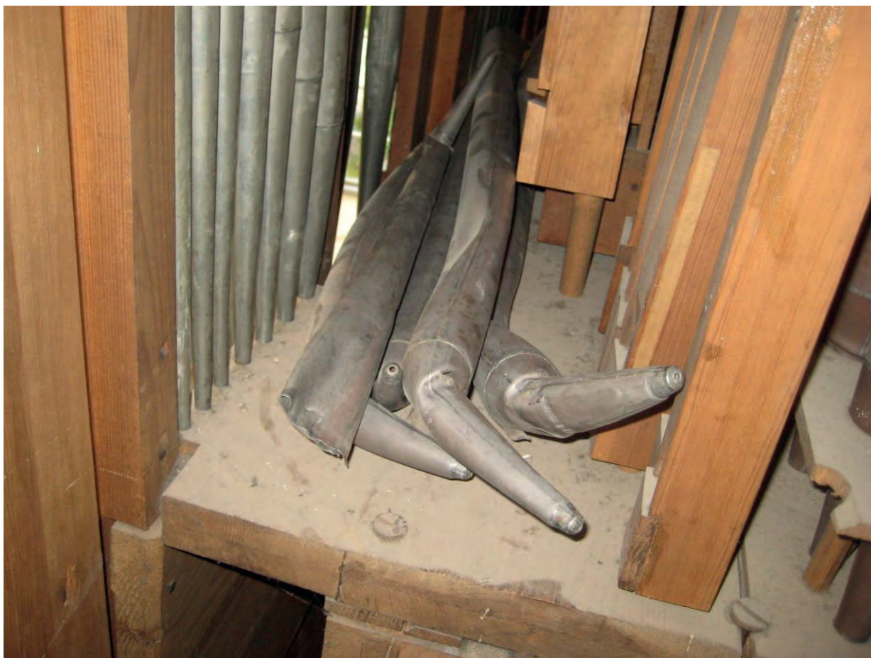
Skadade pipfötter Gamba 4' baspipor
