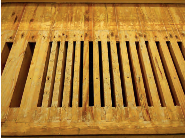
Ventilkistans ovansida med cancellerna efter rentvättning. Den tvärgående balken demonterad. Foto: Bergenblad & Jonsson. Wind chest and grooves after cleaning.
