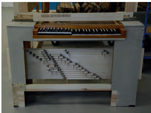
Rekonstruerad vällbräda för den bihängda pedalen. Foto: R. Gullbrandsson. Reconstructed roller-board for pull-down pedal.
