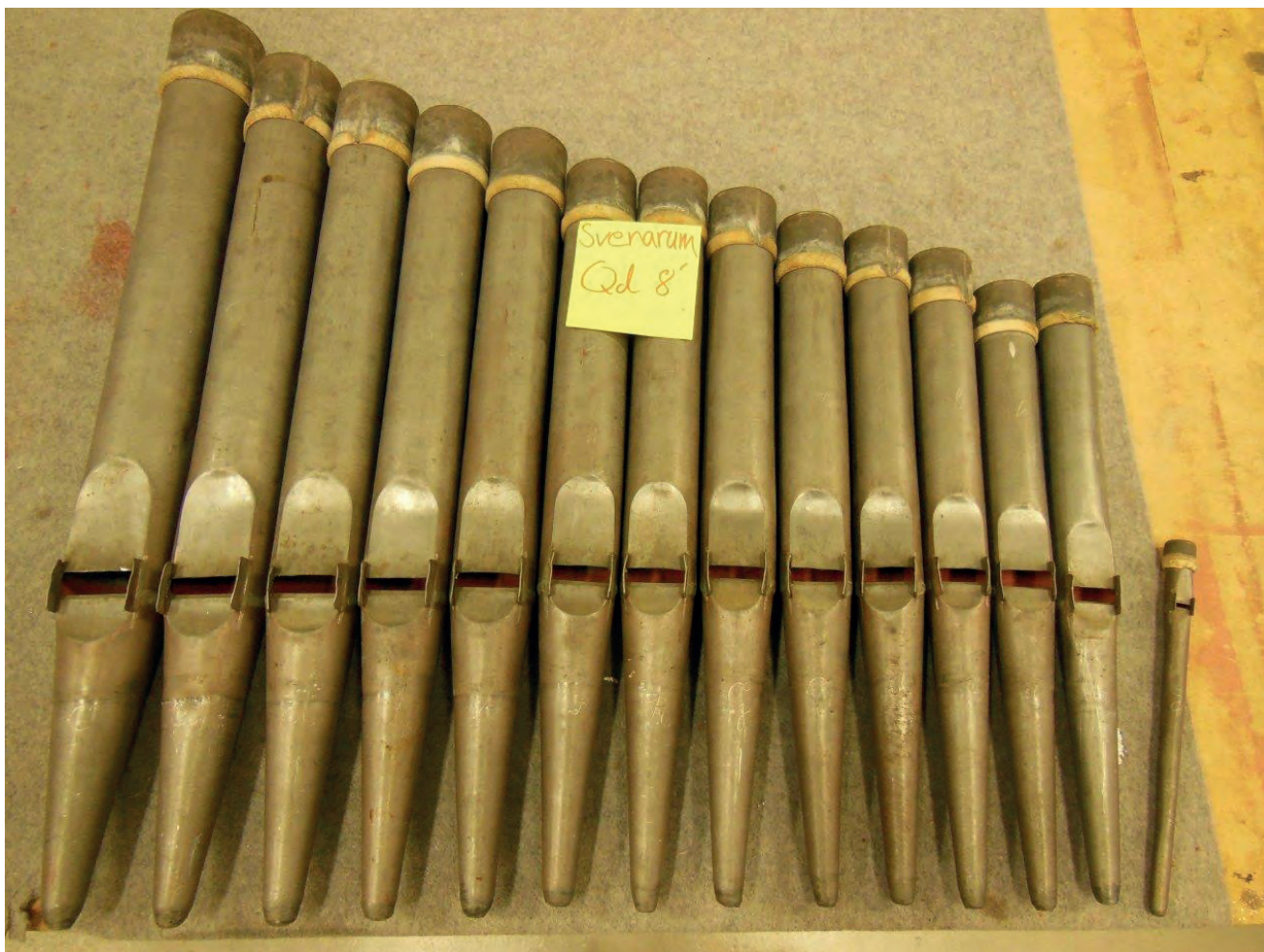
Qvintadenapipor som av Magnusson omarbetats till Borduna 16'. Foto: Bergenblad & Jonsson. Pipes from Qvintadena 8', altered by Magnusson for use in Borduna 16'.
