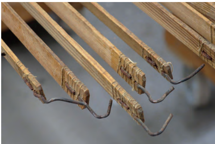
Detalj av ursprungliga abstrakter. Foto: R. Gullbrandsson. Detail of original trackers.
