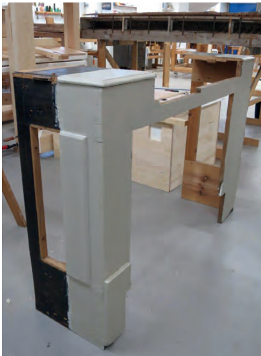
Spelbordet före restaurering. Till vänster syns ursprungliga ytskikt med den svarta originalfärgsättningen. Inga spår fanns av ursprungligt pedalläge. Foto: R. Gullbrandsson. The console before restoration. To the left original black paint.
