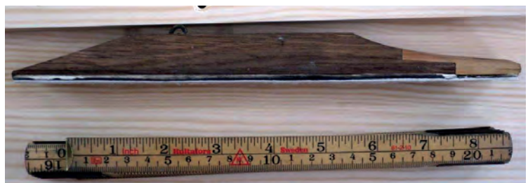
Ventiler av ek, av Magnusson försedda med fasad framkant och svansupphängning. Foto: R. Gullbrandsson. Pallets with changes made in 1865 (tail and reshaped front).
