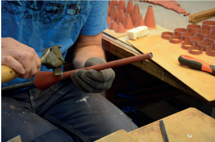
Mats Jonsson under tillverkning av uppsatser till Vox humana 8'D. Foto: R. Gullbrandsson. Mats Jonsson making the new bodies for Vox humana 8'D.
