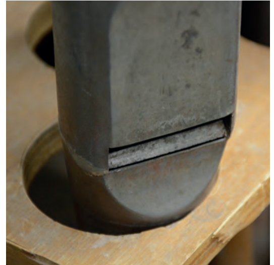
Ett antal av labialpiporna har små tunna, glest och snett sittande kärnstick som kan vara ursprungliga. Här på pipa i Gamba 4'. Foto: R. Gullbrandsson. Small, probably original nicks on pipe in Gamba 4'.
