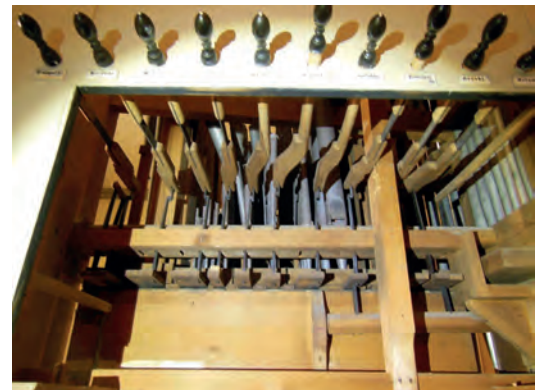
Registratur från 1865. Registersvärden sannolikt ursprungliga. Foto: Bergenblad & Jonsson. Stop action from 1865 with possibly original swords.
