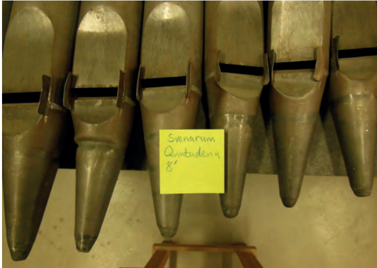
Krökta fötter på baspipor ur Quintadena 8'. Foto: Bergenblad & Jonsson. Deformed feet on Quintadena 8'.
