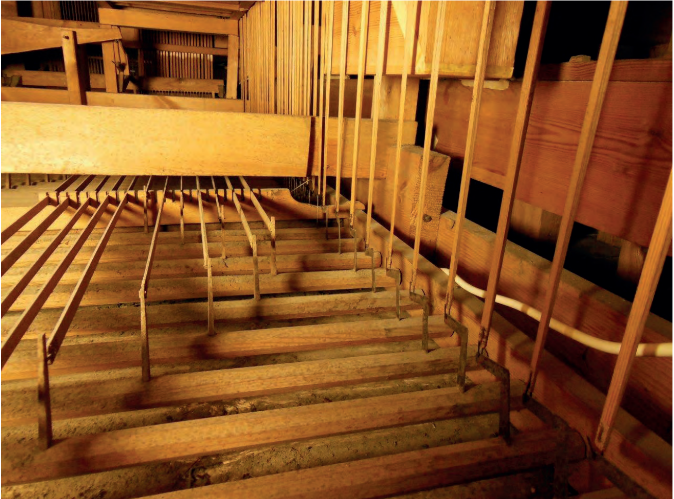
Ursprunglig liggande vällram för manualen. I fonden abstrakterna från denna. Foto: Bergenblad & Jonsson. Original roller-frame for the manual.
