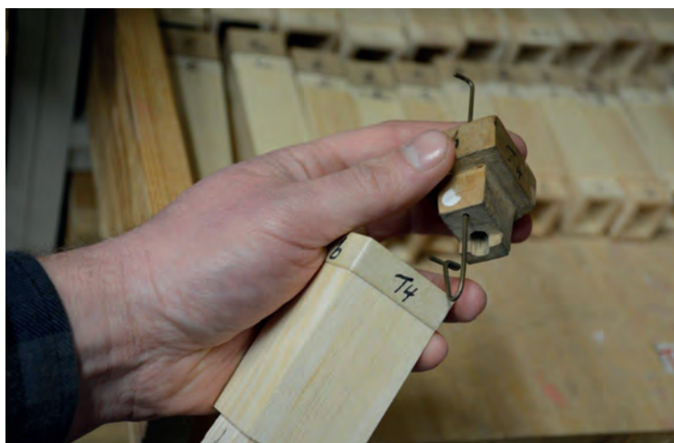
Den bevarade kopfen från b i Trumpet 4'B med ny stövel. Foto: R. Gullbrandsson. The original block for b from Trumpet 4'B with new boot.
