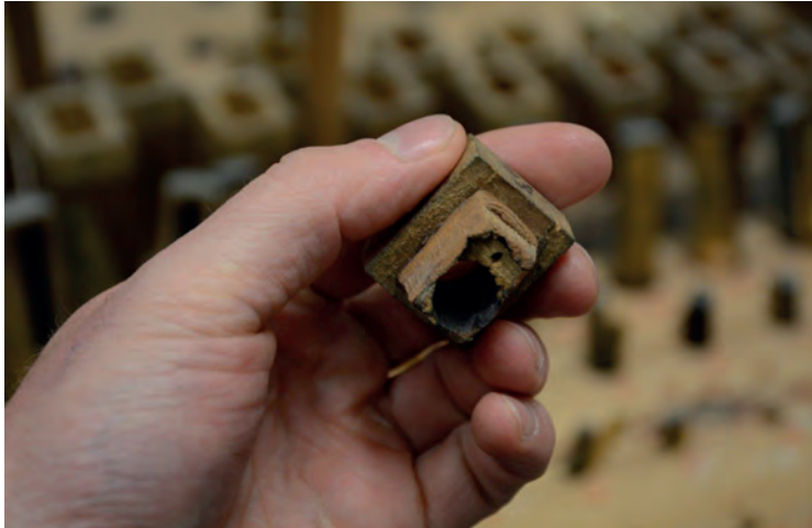
Kopf ur diskanten på Trumpet 8' med hål som borrats upp 1865 för labialpipa ur mixturens borttagna oktavor. Foto: R. Gullbrandsson. Block from Trumpet 8' with 1865 enlarged hole for a labial pipe.
