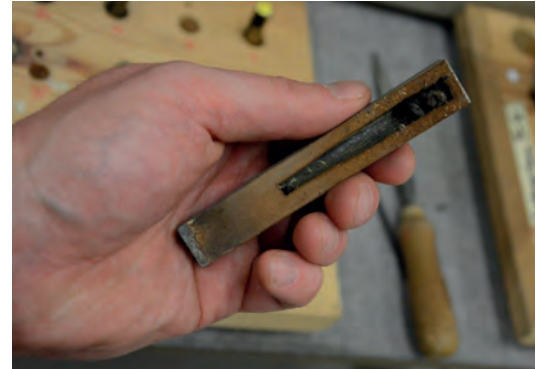
Belädrat munstycke ur Trumpet 8' Foto: R. Gullbrandsson. Shallot with leather.
