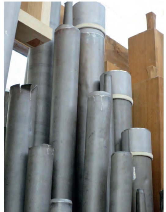
Lagade mynningar på Gamba 4' och kompletterande stämhattar på Qvintandena 8'. Foto: R. Gullbrandsson. Repaired tops on Gamba 4' and new canisters on Qvintadena 8'.
