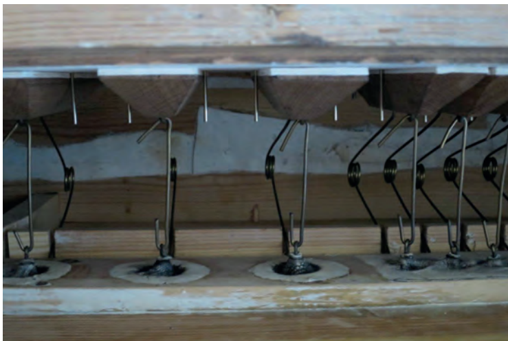
Ventilkistan efter restaurering. Rengjord med ny belädring på ventilerna, i övrigt oförändrad. Foto: R. Gullbrandsson. Inner of wind chest after restoration, pallets left in their 1865 state.
