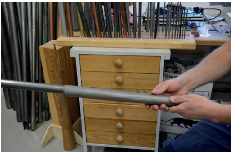
Uträtning av böjd pipa i Gamba 4'. Foto: R. Gullbrandsson. Straightening of deformed pipe from Gamba 4'.
