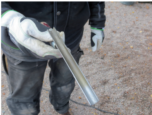
Muraren Roland Bergsten visar fogstrykaren med 14 mm:s diameter.
