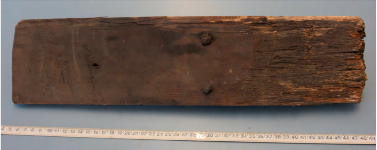
Tillvarataget spån nr 2: Ovansida med dubbel spikning och vissa spår efter rödtjärning.
