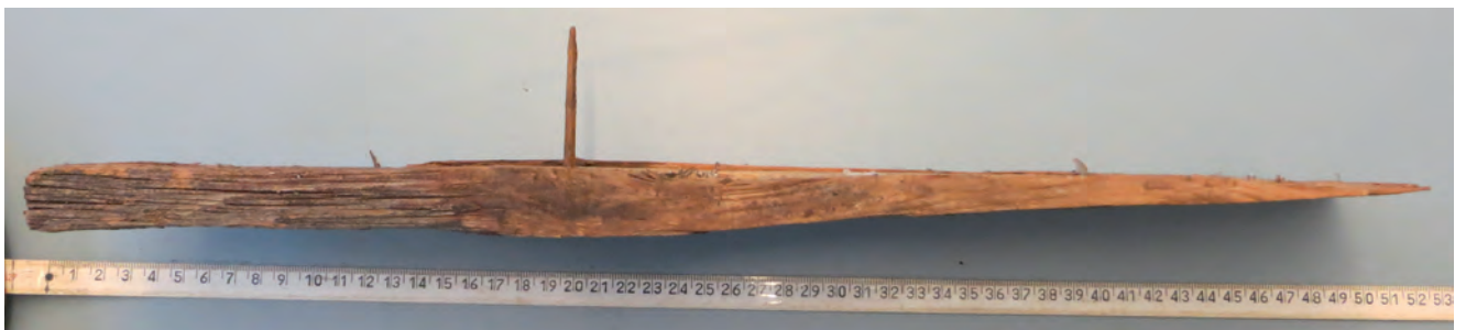
Tillvarataget spån nr 1: Sida med en bevarad handsmidd spik.
