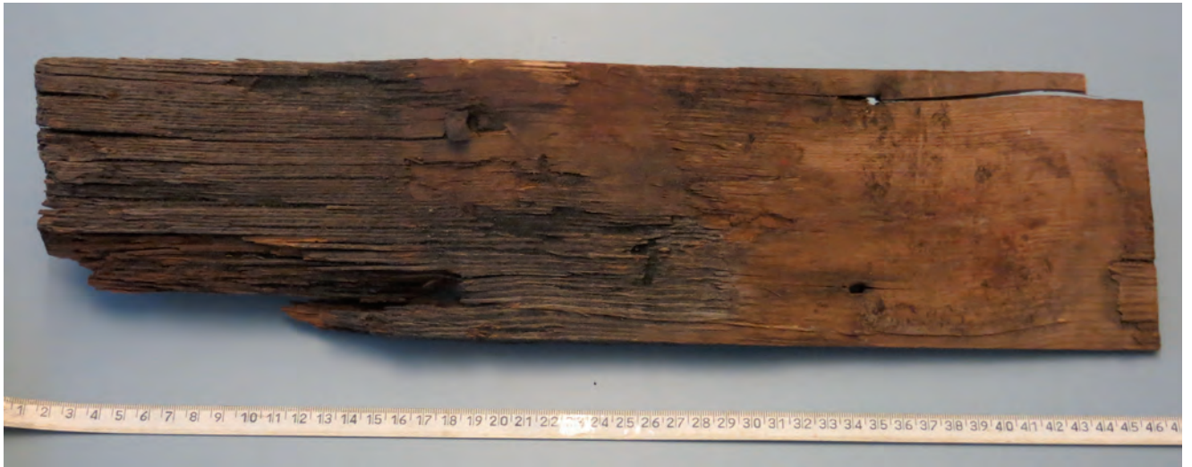
Tillvarataget spån nr 1: Ovansida med dubbel spikning och vissa spår efter rödtjärning.
