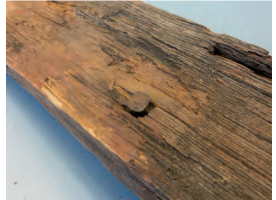
Detalj av spån nr 1 med spik och väderbiten översida vid gränsen för bleket.
