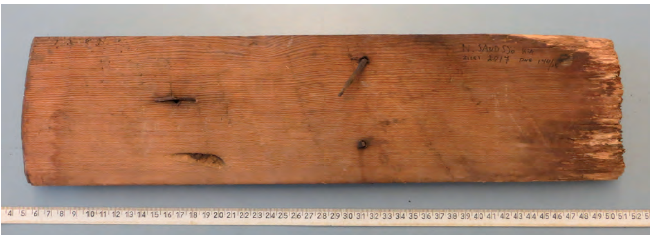
Tillvarataget spån nr 2: Undersida med dubbel spikning och inga synliga spår efter tjärbehandling.
