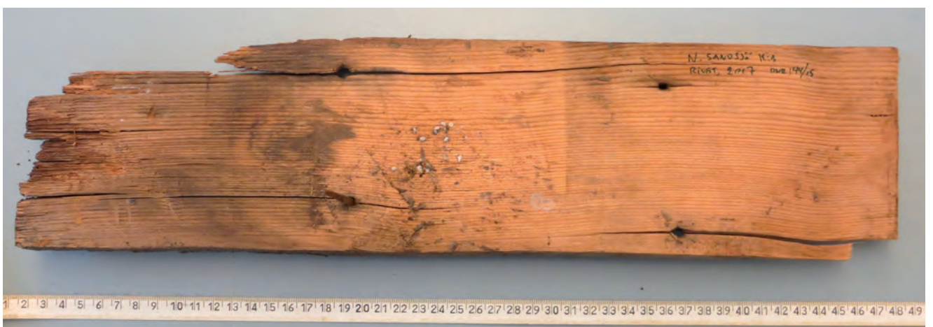
Tillvarataget spån nr 1: Undersida med dubbel spikning och inga synliga spår efter tjärdoppning eller strykning.
