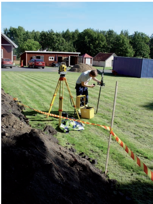
FIGUR 4. Dokumentation med hjälp av digital inmätning. Foto: Kristina Jansson.
