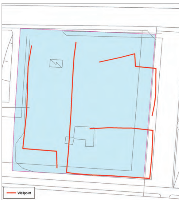
FIGUR 13. Wellpointsystemets placering inom den undersökta ytan.
