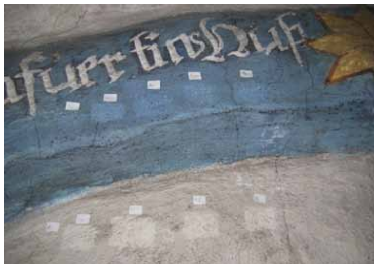
Prover inför val av saneringsmetod för kyrkorummets valv- och väggmålningar.
