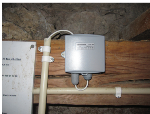
Ovan: Givare på kyrkvinden för kontroll av klimat.
