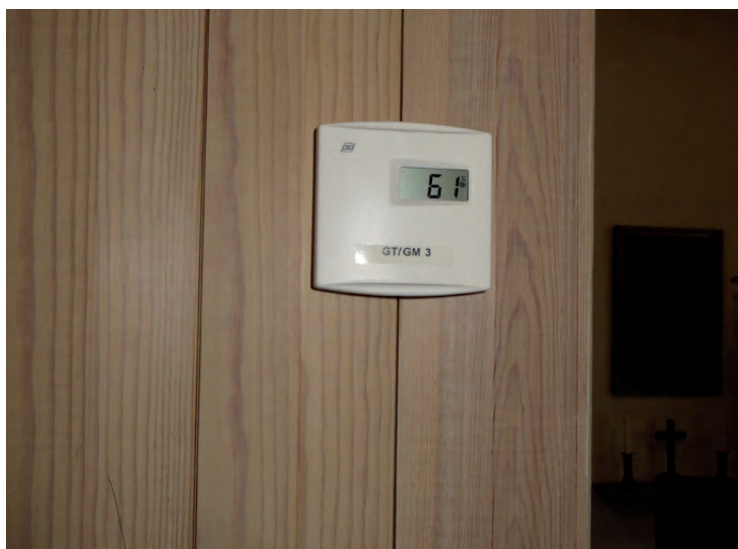
Givaren i sakristian monterades på skrudskåpets norra sida. Displayen visar aktuell RF.
