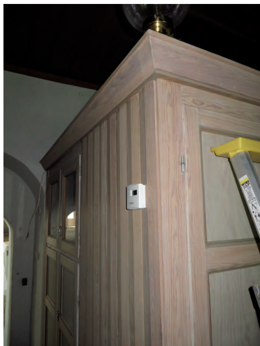
Givaren i sakristian monterades på skrudskåpets norra sida. Displayen visar aktuell RF.
