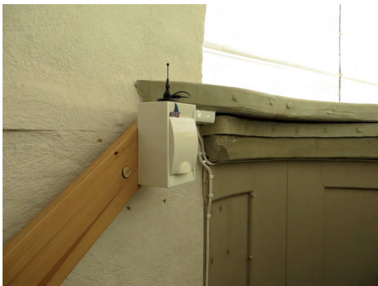
Den interna sändaren och mottagaren för de trådlösa givarna placerades i altarpredikstolen och monterades på den moderna ledstången.
