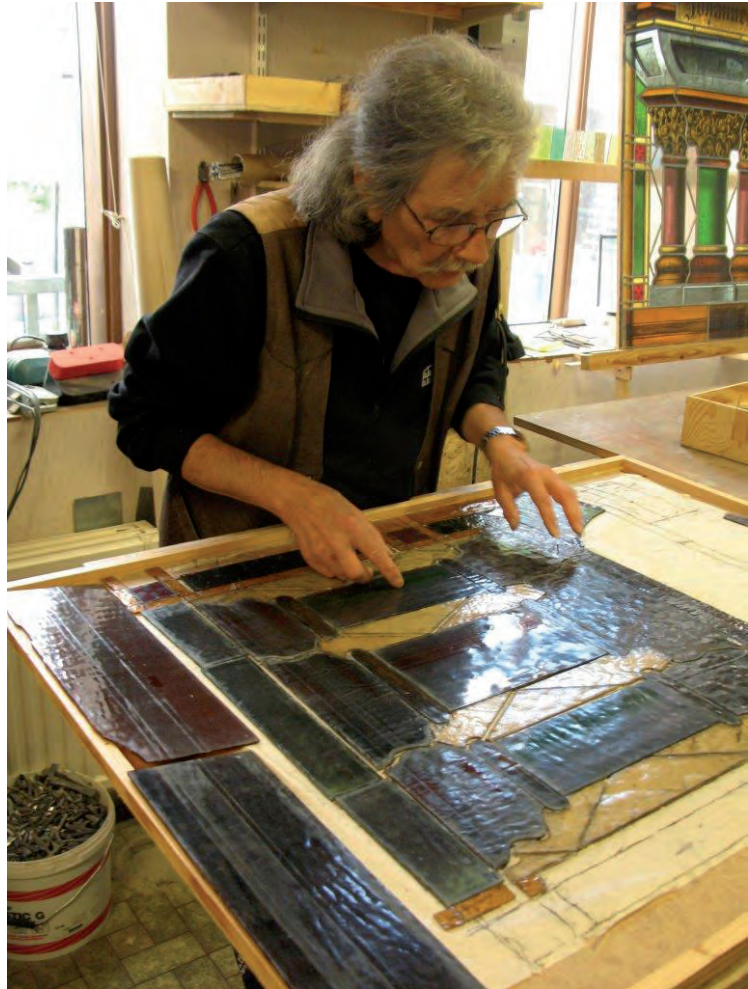
Glasmålare Jörg Wasser under arbete med nederpartiet till "Lucas". Glas under utläggning på kartong för omspröjsning med nytt bly.
