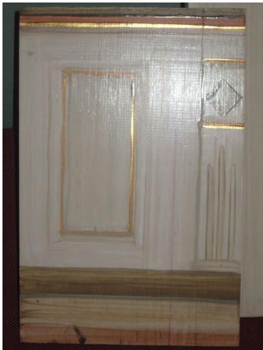
Ovan och nedan: Vid projekteringen av bänkmålningen gjordes uppstrykningsprov både på bänkarna och på skiva som dokumentation och referens.
