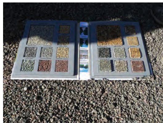
Provkartan på olika ballastmaterial i klistringen jämfördes med befintligt grus.
