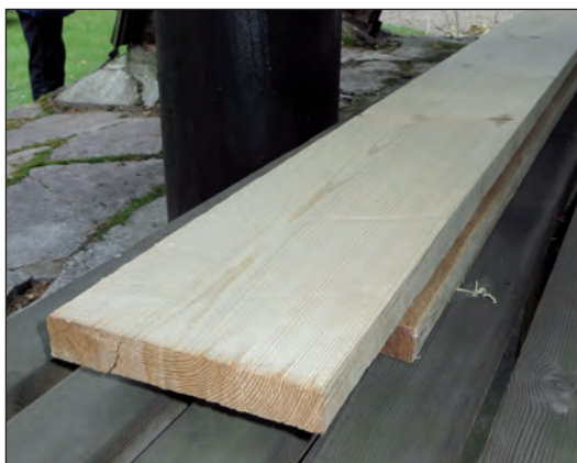
Panelen på samtliga strävpelare i paviljongen byttes ut mot likadan, d v s cirkelsågade furubrädor av hög kvalitet.
