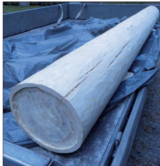
Kärnfuru av hög kvalitet och rottdelar av stocken valdes medvetet eftersom dessa har en större andel kärnved. I kolonnbasen svarvades en droppkant.
