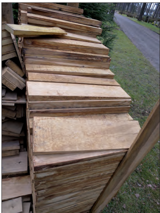
Bandsågade ekspån av standardformat, tillverkade i Tyskland, användes vid omtäckningen.
