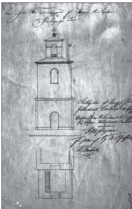
Ritning till nytt torn på Skepperstads kyrka 1809. Lanterninen var från början öppen, vilket förklarar varför torntakets äldsta spåntäckning täckte hela takytan.
