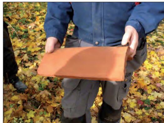
Nocken täcktes med nytt handslaget nocktegel från Horns tegelbruk.
