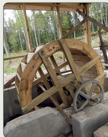
Det nya vattenhjulet rekonstruerades utifrån bevarade rester samt ett fotografi från 1950-talet. Foto Jönköpings läns museum.
