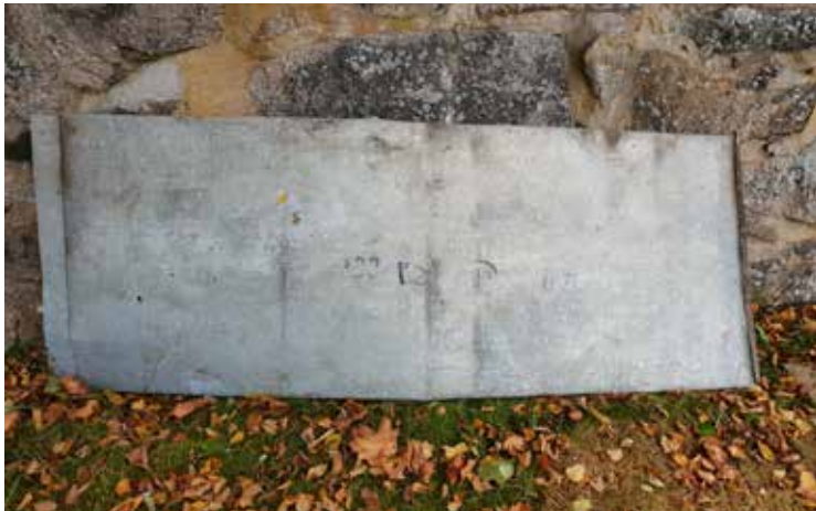
Stämpel på plåtens baksida.
