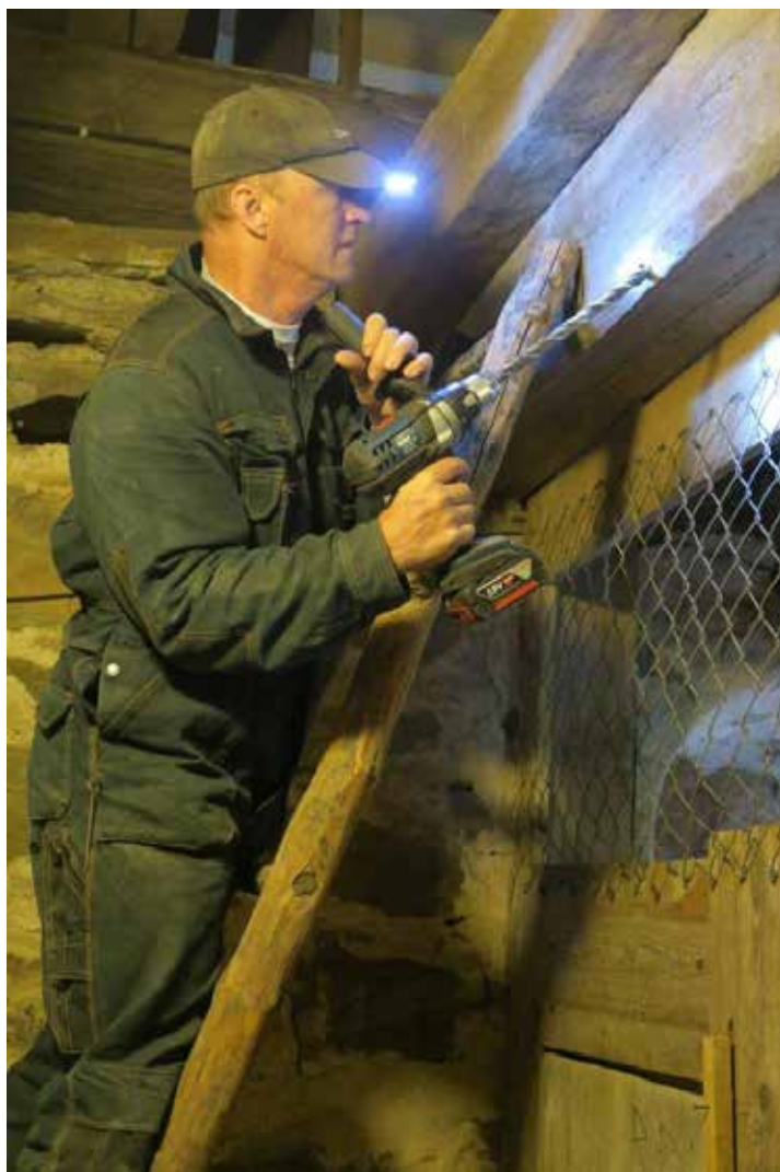
Dendrokronolog Hans Linderson, Lund, tar prov (nr 3) i klockbjälke i tornet, vilket kunde dateras till vinterhalvåret 1274/75. Foto: Robin Gullbrandsson.
