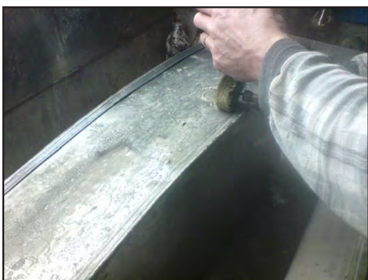
Kratsning med quillayabarkspulver. Foto: Cai Zetterström.
