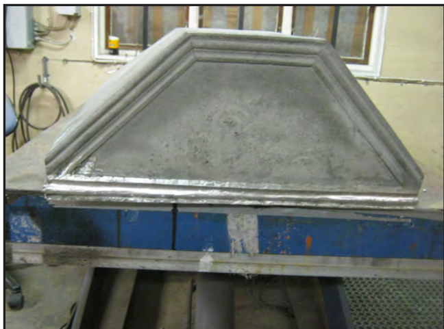
Huvudgavellisten färdiglödd och delvis formgiven. Foto: Cai Zetterström.
