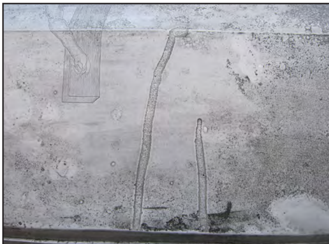
Renhetsgrad efter borttagning av oxidskikt. Foto: Cai Zetterström.
