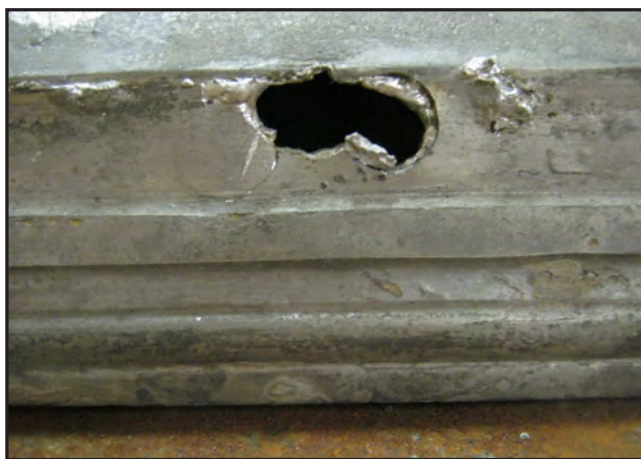
Lödning från 1932 har smält pga för hög värme. Foto: Cai Zetterström.
