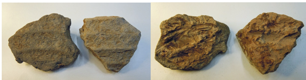
Fig. 3. Foto av innerformsfragment (F42) med halmavtryck på baksidan (höger) och fingerdragna ränder på utsidan (vänster) för fästande av ett särskilt gjutytalager.
