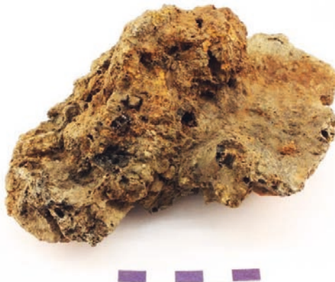
Figur 3:18. Prov 5, insidan av ugnsväggsfragment med smält lera och ett rostigt magnetiskt område överst.
