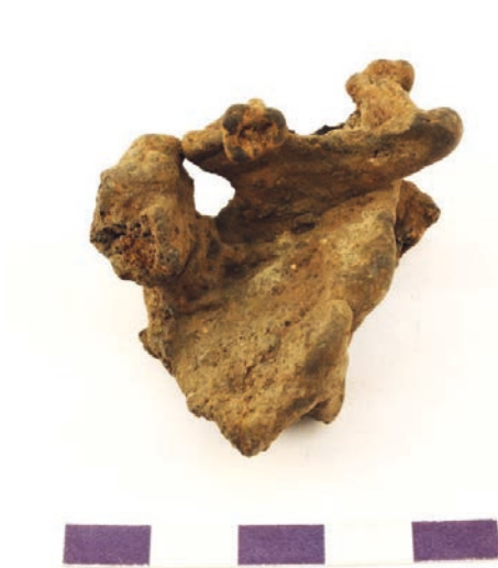
Figur 3:1. Prov 1, liten slagg med flera tunna slaggsträngar.
