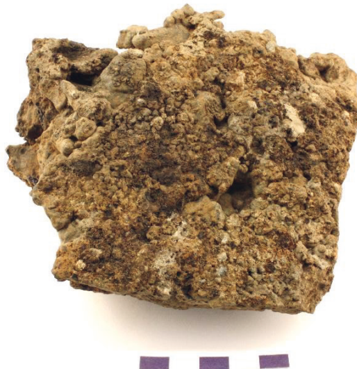
Figur 3:22. Prov 6, detalj från bottenytan på bottenslagg flera små slaggsträngar som stelnat mot grusigt underlag.
