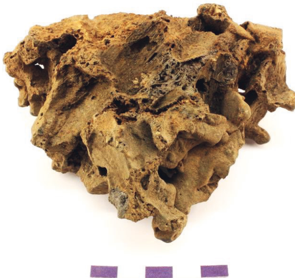
Figur 3:13. Prov 4, överytan på bottenslaggen, mer trögfluten och med kolavtryck.
