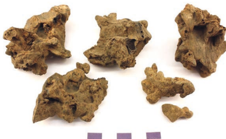
Figur 2. Prov 3, flera små slaggar uppbyggda av flera pålagrade slaggsträngar; och med flera kolavtryck (se även bilaga 3).
