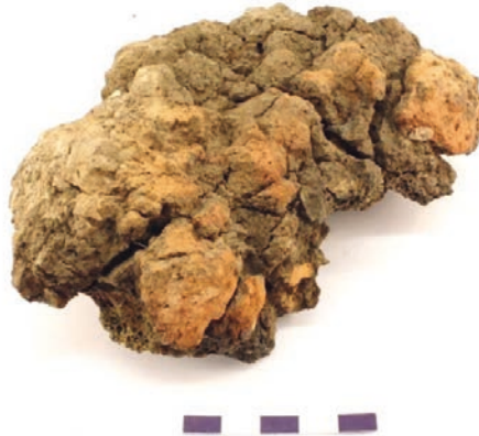
Figur 3:17. Prov 5, utsidan av ugnsväggsfragment med rödbränd lera
