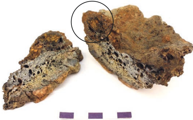
Figur 3:19. Prov 5, ugnsväggsfragment i tvärsnitt. Skiktningen från rödbränd lera på ugnens utsida (nederst i bild) via ett skikt av smält lera eventuellt med slagginblandning i mitten, och innerst (överst i bild) ett magnetiskt rostbrunt skikt. Cirkeln markerar delen som har valts för metallografiska analyser (polerprov).
