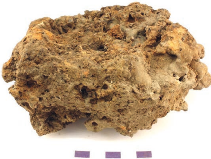
Figur 1. Bottenslagg (prov 6), något skålformad och med trögfluten, rostbrun överyta (se även bilaga 3).
