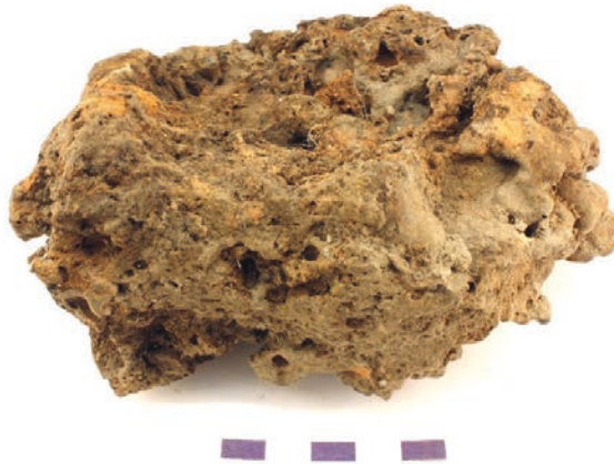
Figur 3:21. Prov 6, något skålformad bottenslagg med trögfluten, rostbrun överyta.
