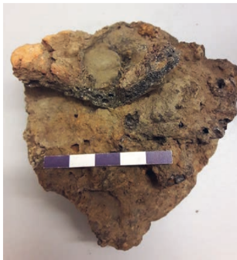
Fig.2. Foto av insidan av ugnsvägg, där en del av insidan gått loss och vikts ner under körningen.
