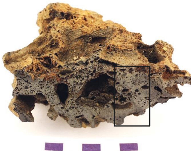
Figur 3:14. Prov 4, delat tvärsnitt av bottenlaggen som har analyserats kemiskt. Centralt ses ett stort hålrum med kolrester. Området till höger om detta är analyserat i mikroskop (tunnslip).
