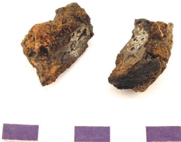
Figur 3:6. Prov 2, delat snitt med huvudsakligen korroderat material. Den vänstra delen har provtagits för metallografisk analys. Kolstycket i nedre högre delen har provtagits för vedartsanalys och datering.
