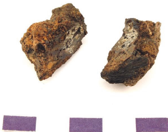
Figur 6. Prov 2, delat snitt med huvudsakligen korroderat material. Den vänstra delen har provtagits för metallografisk analys. Kolstycket i nedre högra delen har provtagits för vedartsanalys och datering.
