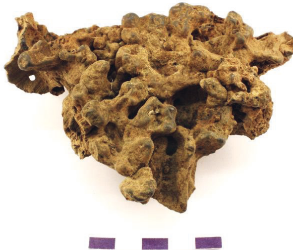
Figur 3:12. Prov 4, bottenytan på bottenslagg som är uppbyggd av flera pålagrade slaggsträngar.
