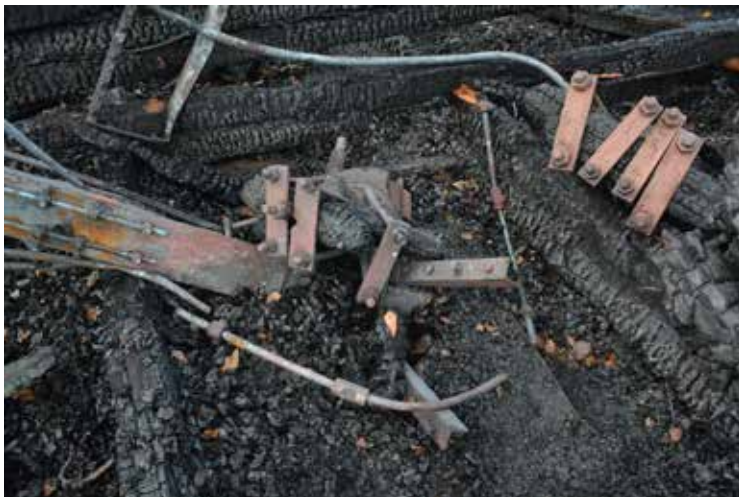
Klockornas upphängning och de avslagna kronorna. Järnstativet till vänster i bild är delar av trampanordningen till klockringningen.
