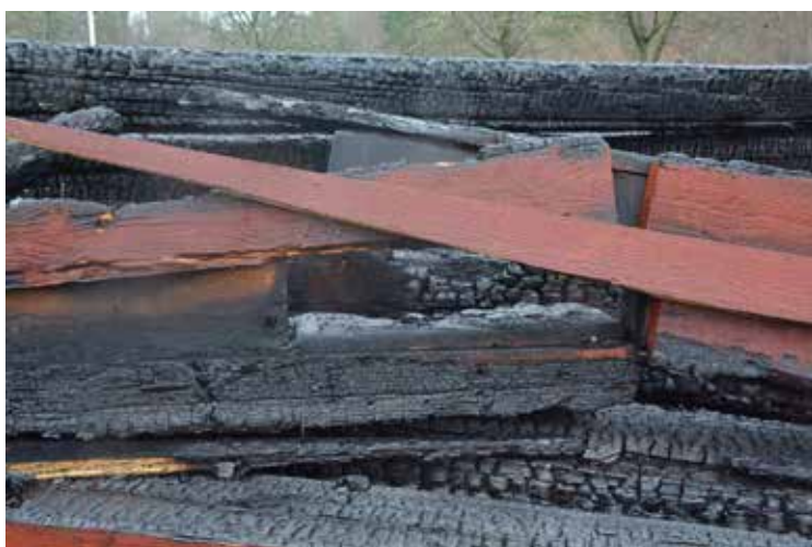
Flera av de skarvade stödbenen hade delat sig i skarvarna.
