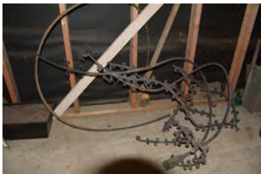
Det smidda järnklotet som var undanställt i klockstapeln deformades av värme och nedfallande material.
