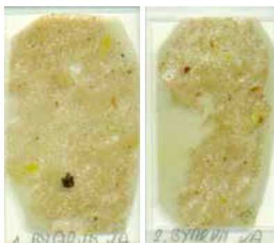
Tunnslipspreparat mellan täckglas, skala 1:1. Här syns exempelvis stora kalkklumpar och fingeraderad sand med blotta ögat.
