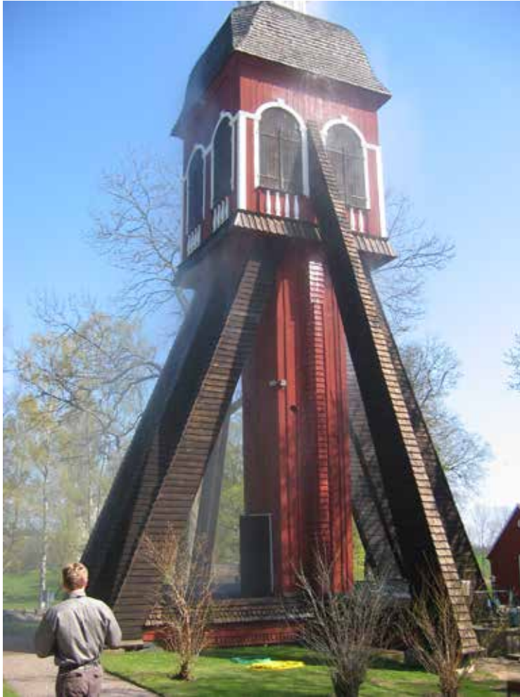
Fullskaletest av sprinklern på klockstapeln, maj 2006.
