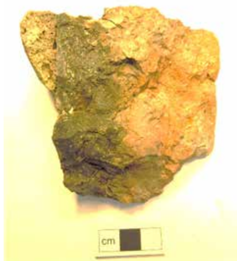
Fig.1. Tegelsten från Kv. Dvärgen (F 37) med sintrad del (mörkfärgad del) och rest av delvis förglasad, blåsig lerbodring/lagning överst till vänster. Rest av smältugn.
