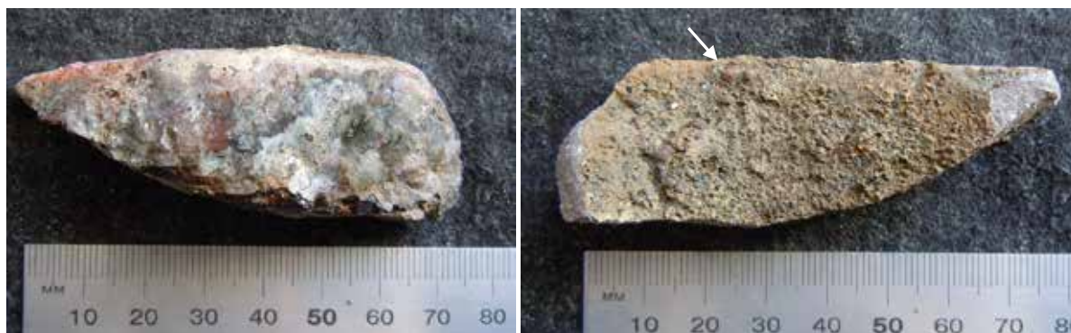
Fig.6. Foton av utsida (vänster) och insida på degelskärva (F22) med tjockt sintrat/förglasat, rödfärgat lager på utsidan och flera millimeterstora smältdroppar av gulmetall på insidan (pil).
