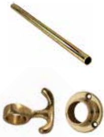
KLÅDHÄNGARE Rör, sidofästen och krokar i mässing. Hängs upp i nisch symmetriskt på bägge sidor om pardörrar till vapenhuset. Fästs i sidan av nisch för att slippa håltagning i puts. Fullbredd ca. 2,20 m. En rad monteras långt ut i nisch på standardhöjd, en rad längre in och lägre för barnkläder.
