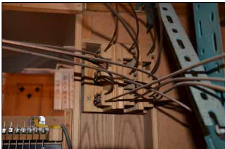
Överföringen från registerandragen till registersvärden som drar slejferna (till vänster) sker via "bowdenkablar". Registersvärden är av mahogny.
