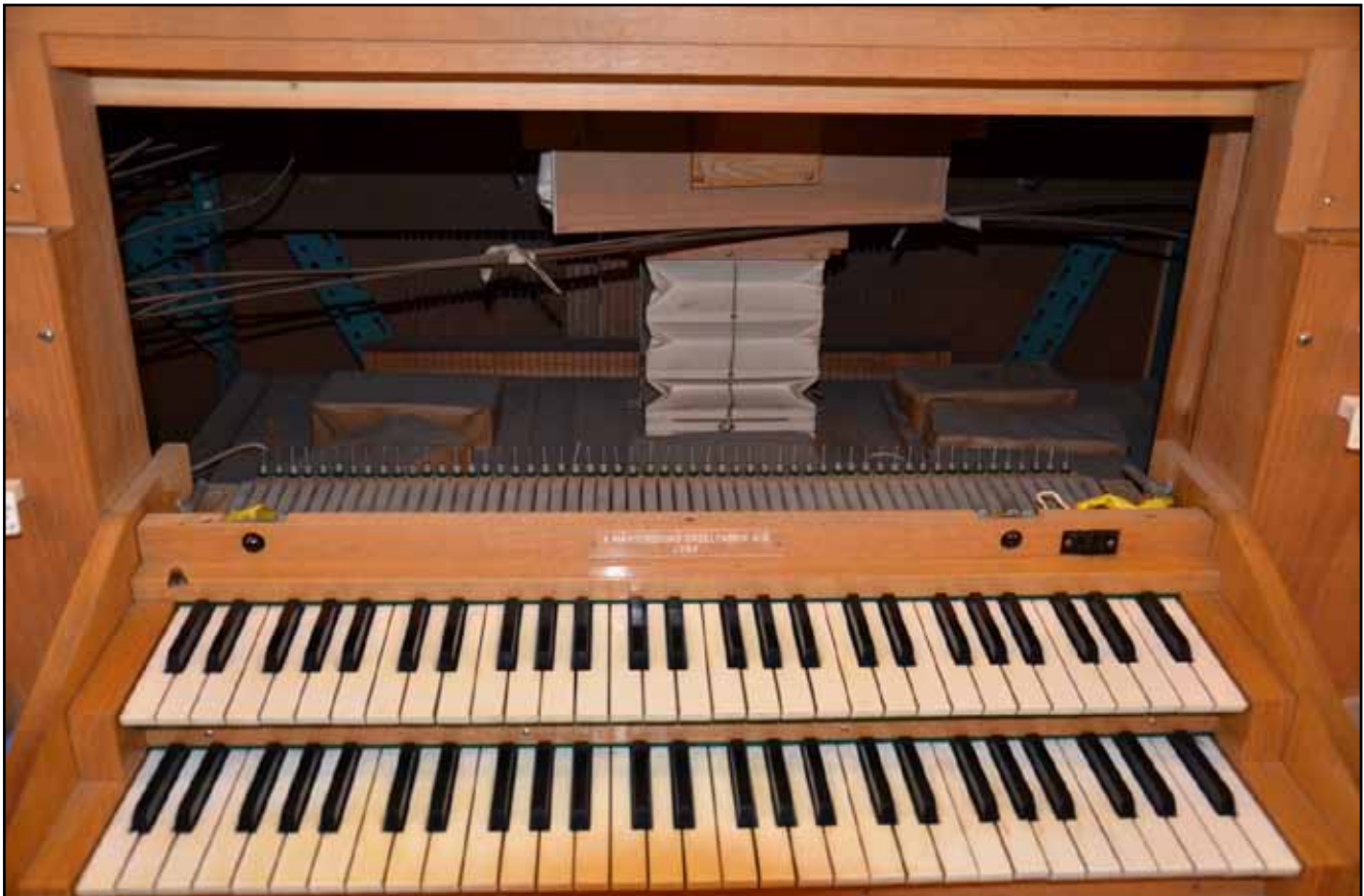
De båda manualerna har balanserade taster med blyvikter och filtlagring. I bakgrunden skymtar stötdämparen till bälgen.
