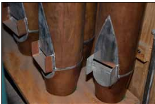
Kopparuppsatser i basen på Kvintadena 8' och Flöjt 4', båda med spetslabier i tenn.
