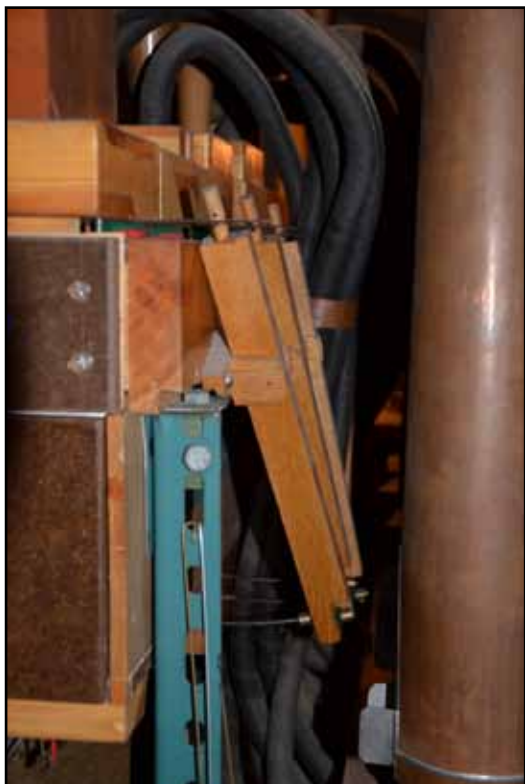
Överföringen från registerandragen till registersvärden som drar slejferna (till vänster) sker via "bowdenkablar". Registersvärden är av mahogny.
