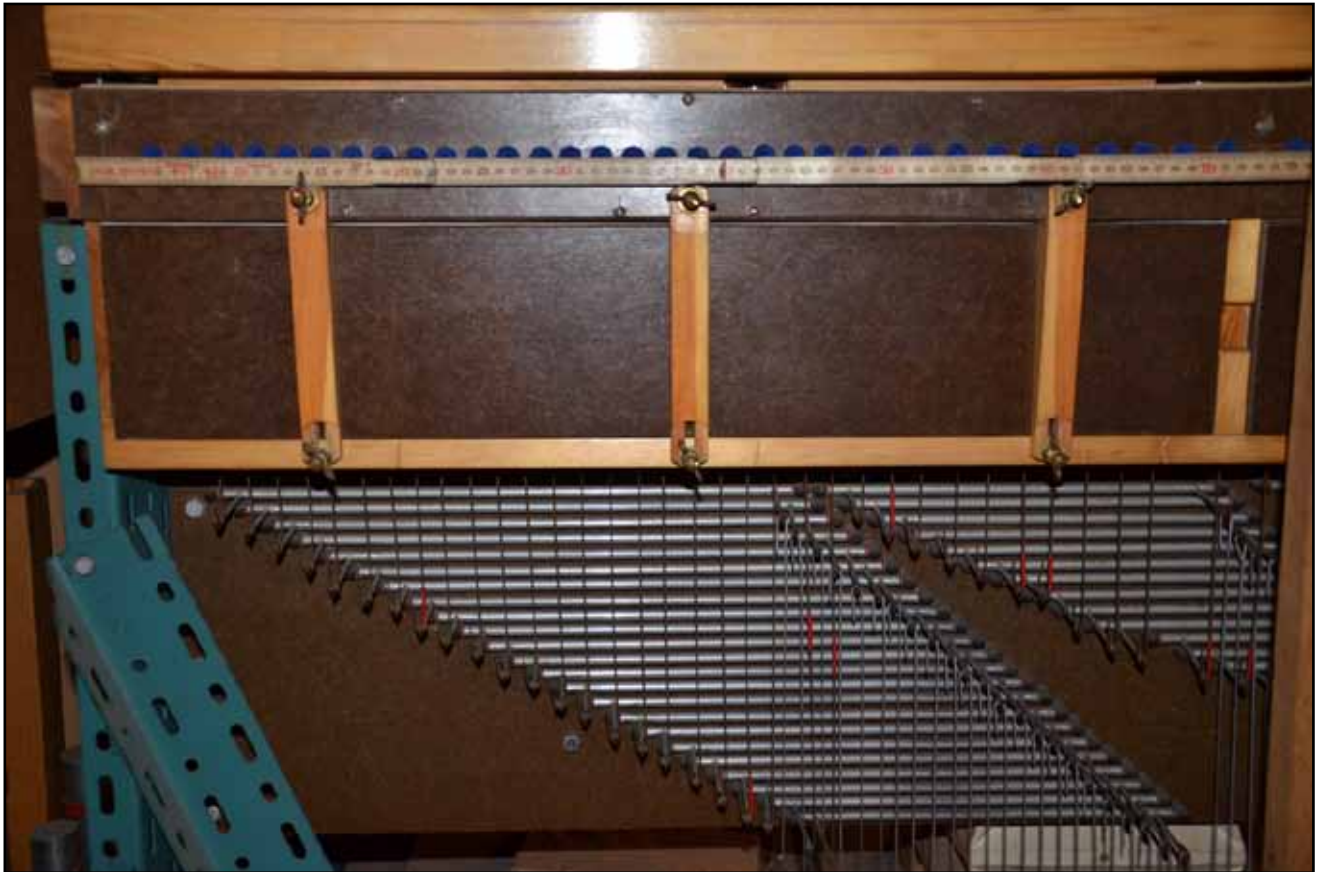
Bilden ovan: Svällverkets väderlåda i furu och masonite samt därunder vällbrädan för manual II, likaså i masonite. Vällar och armar i aluminium. Notera bärverket av stålprofiler. Bilderna nedan till höger: Registerandrag i vit bakelit.
