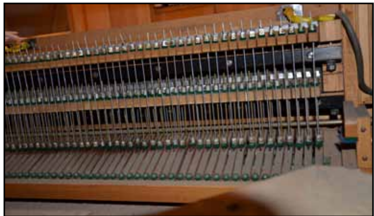
Abstraktupphängningen på de båda manualerna. Filtlagring. Abstrakter av aluminiumtråd. Nedtill vippbräda för koppel I/II.
