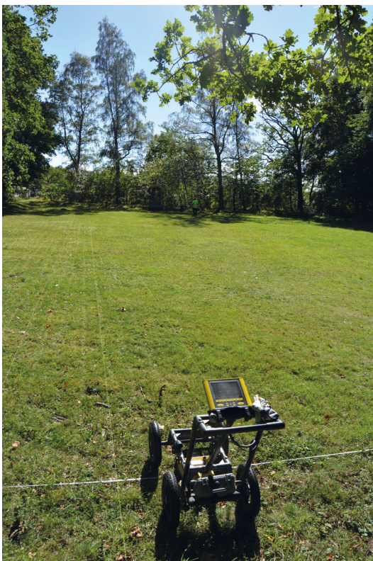
FIGUR 13. Georadarn, Sensor & Software NogginPlus 500 MHz, är redo att starta. Foto Mikael Nordström.
