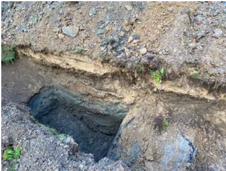
Figur 8. Rester efter krossad asfalt i fyllningen, och längre ner blålera.
