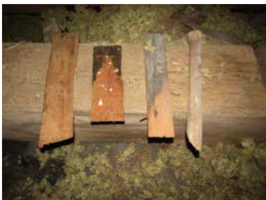
Några av de föremål som upptäckts i samband med att vindens städades från stenullsisoleringen. Olika spån och en dymling.
