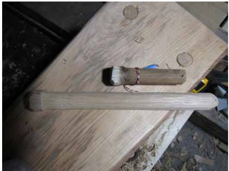
En äldre, avbruten dymling och en ny tillverkad. Dymlingarna täljdes på plats uppe på vinden för att kunna anpassas till varje knut.
