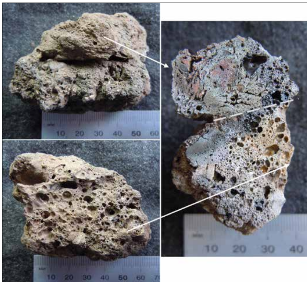
Figur 20. Utsida (övre vänster) och insida (nedre vänster) av schaktfragment bestående av grovt gods i den nedre delen och fint, växtmagrad gods i den övre (tvärsnitt till höger, där den brutna linjen anger övergången). Ugn A645. Foto Ole Stilborg.
