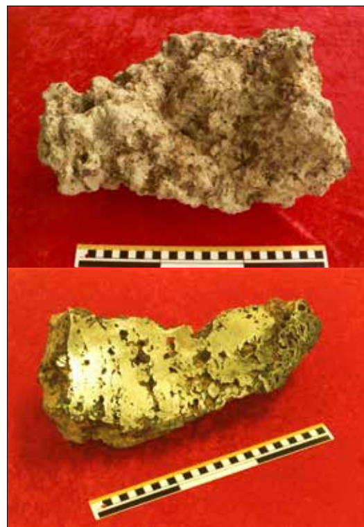
Figur 4 och 5. Lupp hel och delad, daterad till 600-tal e.Kr., vikt 25 kg. Från Torsåkers sn i Gästrikland. Luppen kommer således från samma socken som Dansarberget men har en senare datering.
